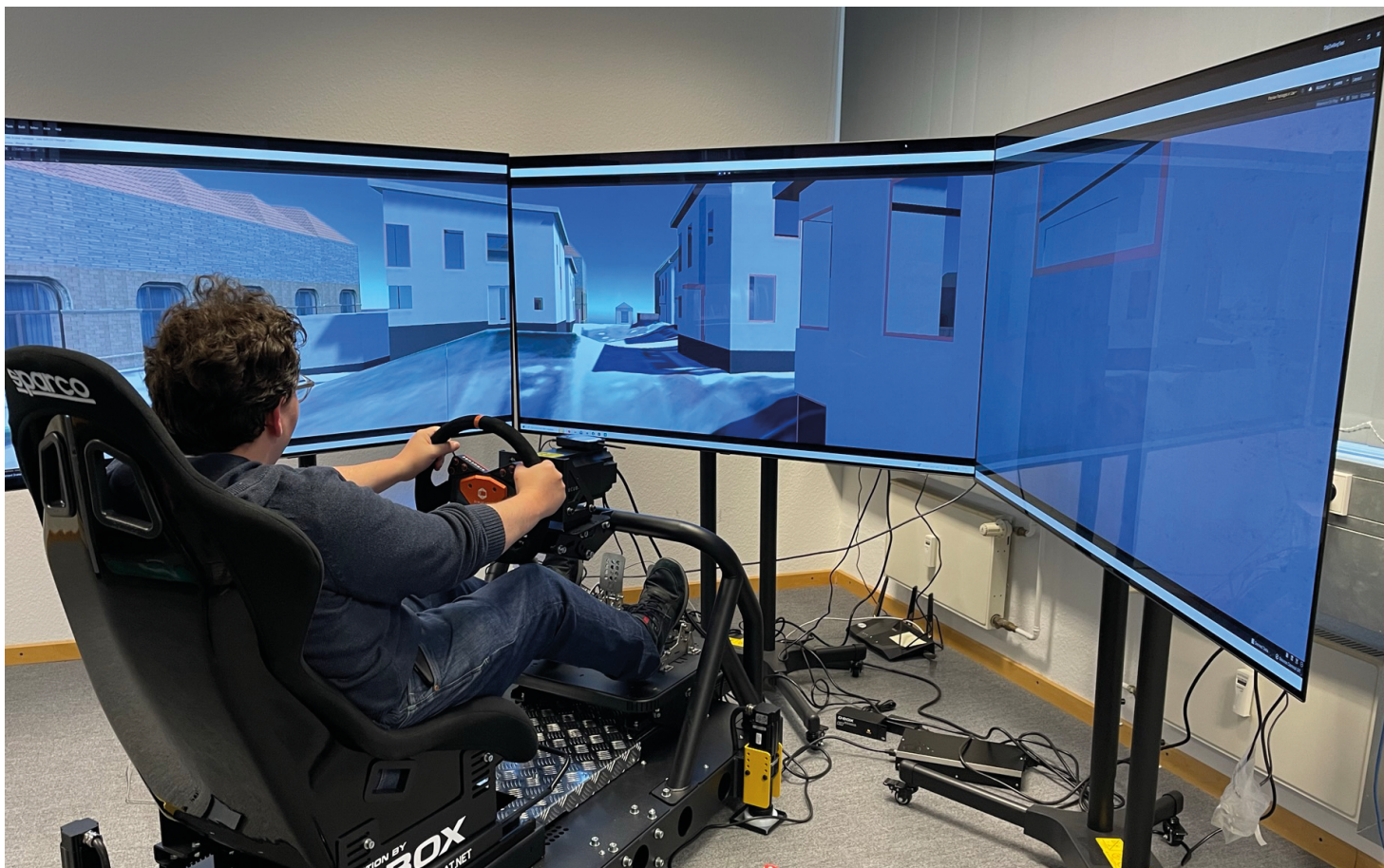
Anwendung des Fahrsimulators innerhalb des Forschungslabors zum Erkunden des Reallabors in entwickelter 3D-Umgebung vom Klimaviertel Herne. Using a driving simulator in the research lab to explore the living lab using a 3D model of the neighbourhood "Klimaviertel" in Herne.
