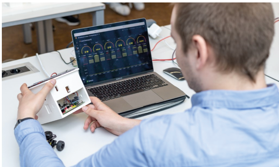
Nutzung eines Smart-Energy-Miniaturmodellhauses mit Datenanbindung an Smart-City-IT-Plattform Use of a smart energy miniature model house with data connection to the smart city IT platform
